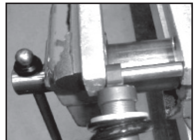
Centrado de las piezas de aluminio en el torno de banco
