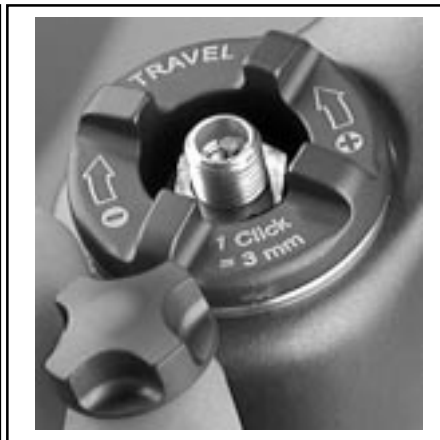
Fig. 2 TALAS Air Top Cap Knob & Schrader Valve
