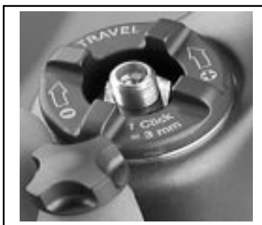
Fig. 2 TALAS Air Top Cap Knob & Schrader Valve
