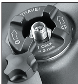
Fig. 2 Manopola del tappo superiore dell'aria TALAS e valvola Schrader TALAS
